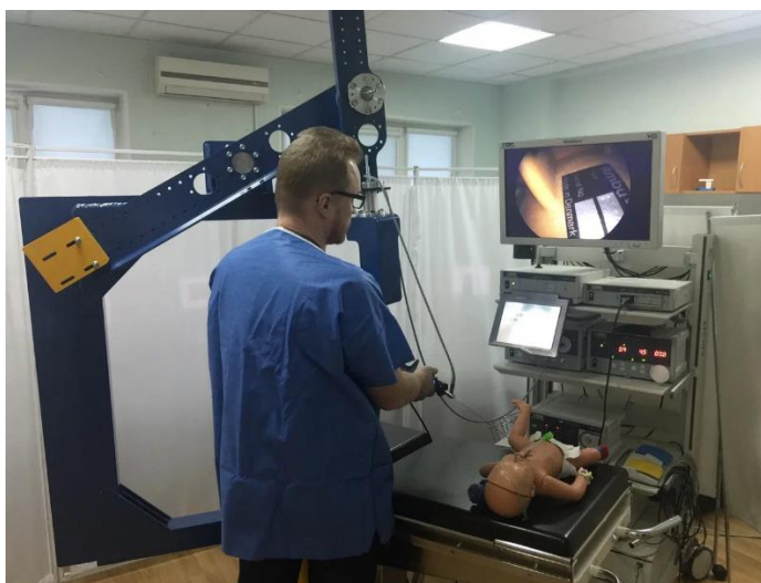
Рисунок 45 – Испытательный стенд. Тестирование балансировки манипулятора
